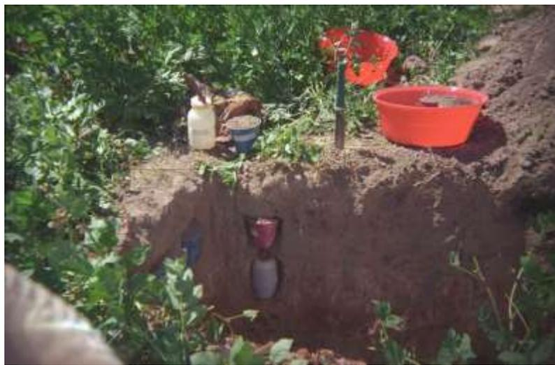
Фото 4. Установка сорбционных лизиметров в профиле пахотной почвы
