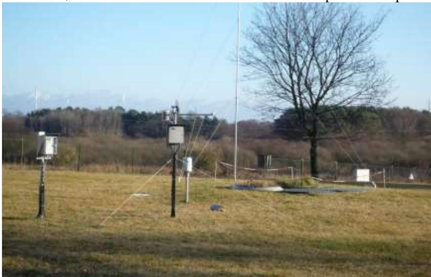
Фото 1. Лизиметрическая станция в г. Мюнхеберге (Германия): телескопическая антенна и приборы, оценивающие состояние атмосферного воздуха и «дыхание» почвы. Результаты измерений автоматически передаются на компьютер, установленный недалеко в специальном павильоне (фото Яшина И.М., декабрь 2011 г.), подробности на сайте [www.ugt-online.de](http://www.ugt-online.de)
