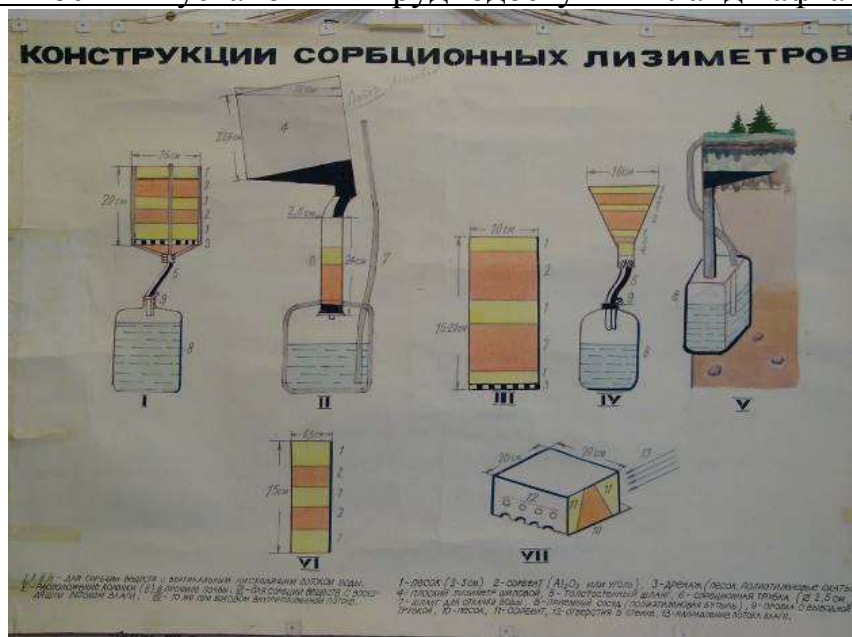
Рис.5. Конструкции сорбционных лизиметров, наиболее широко используемых для оценки водной миграции веществ в форме ионов и молекул в почвах: I, IV – предложенные Кауричевым И.С. (1958); II, V, VI – разработка Яшина И.М. (1969-1974, 1993); III, VII – колонки для учета восходящих и боковых потоков мигрантов в почвах на двучленах, апробированные Кашанским А.Д. (1972).
