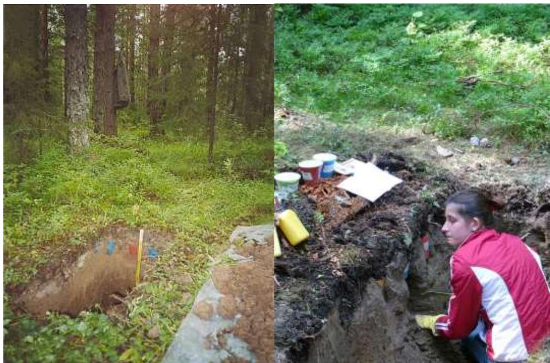
Рис. 8. Использование метода сорбционных лизиметров для оценки коэффициентов миграции  $K_{\text{миг}}$  органических веществ, соединений Fe и тяжелых металлов в почвах таежных стационаров: **А** – фоновый стационар – заповедник - Музей деревянного зодчества «Малые Корелы» под Архангельском; **В** – таежный лесопарк с несанкционированными вырубками и деградированными профилями почв вблизи Петрозаводска, Карелия (фото И.М. Яшина, 2003А; 2009,В).
