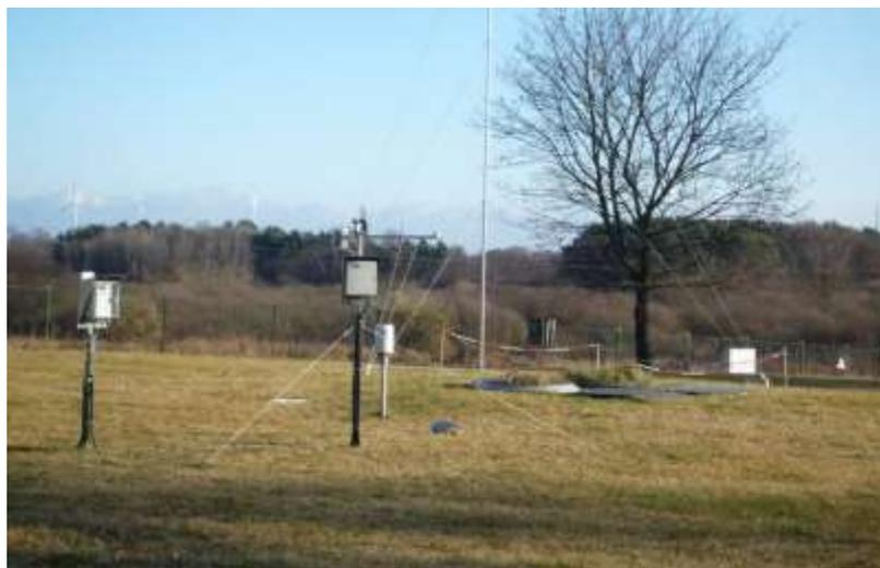
Рис. 53. Лизиметрическая станция в г. Мюнхеберг (Германия): телескопическая антенна и приборы, оценивающие состояние атмосферного воздуха и почвы по данным лизиметров шахтного типа. Результаты измерений автоматически передаются на компьютер, расположенный рядом (в 20-30 м) в уютном специальном павильоне (фото Яшина И.М., декабрь 2011 г.).
