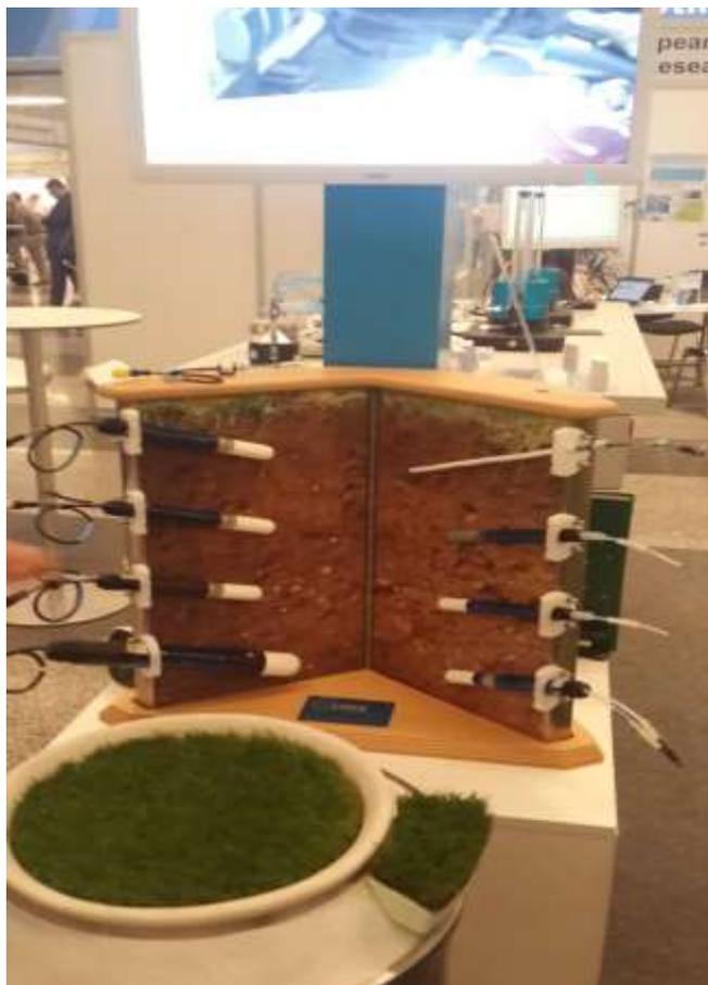
Рис. 40а. Действующая модель вакуумных лизиметров инновационного типа в профиле почвы с выводом полученной информации на компьютер (разработка одной из немецких фирм): Вена, Австрия во время Международного конгресса EGU, апрель, 2015 (фото И.М. Яшина, 2015).
