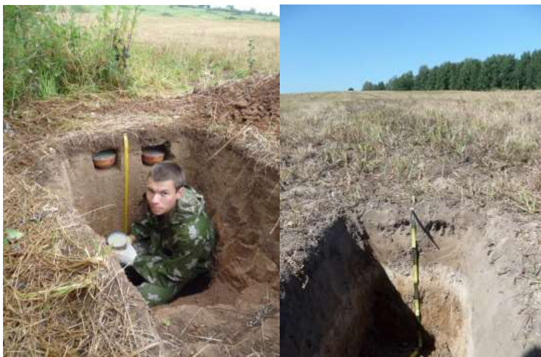
Рис.37. А - студент-эколог РГАУ-МСХА имени К.А. Тимирязева Кашаев Артур устанавливает сорбционные лизиметры в профиле дерново-слабоподзолистой легкосуглинистой почвы во время учебной практики по экологии в учхозе «Дружба» (разрез 2 на 1-й «эрозионной катене» у балки нами рассматривается в качестве фонового ); В – почвенный разрез, заложенный в микро западинке на склоне того же поля (в 85 метрах) диагностируется как дерново-сильноподзолистая среднесуглинистая почва на покровных суглинках (фото Яшина И.М., 15.07.2014).
