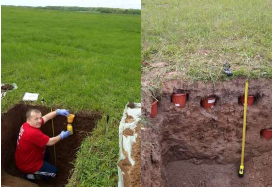
Рис.21. Соискатель кафедры экологии РГАУ-МСХА имени К.А. Тимирязева Р.А. Атенбеков устанавливает сорбционные лизиметры в почвах эко-геохимической катены на окультуренном сенокосе ОАО «Дружба» Переславль-Залесского района Ярославской области для учета водной миграции веществ (фото И.М. Яшина, июнь 2015).
