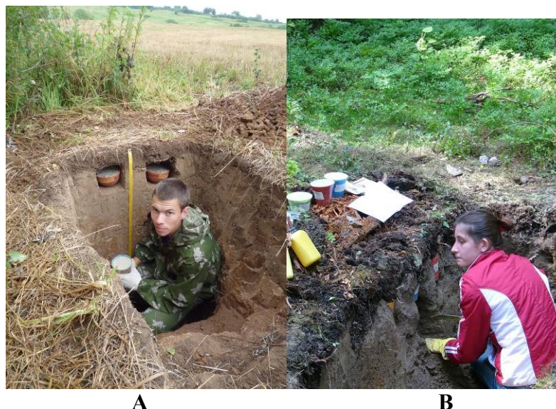
Рис. 30. А – сорбционные лизиметры в почве учхоза «Дружба» Ярославской области устанавливает студент-эколог РГАУ-МСХА имени К.А. Тимирязева Кашаев Артур; В – студентка-дипломница Наумова Елена устанавливает СЛ в профиле деградированного подзола в лесопарковой фации Петрозаводска (фото Яшина И.М., 2014, 2009).
