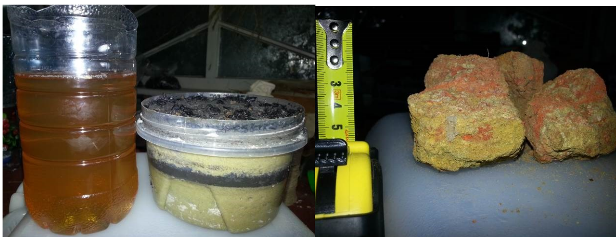
А В Рис. 20. Модельный лабораторный опыт по изучению состава мобилизованных в раствор гуматов и фульватов натрия из гор. А 1 чернозема деградированного супесчаного после пожара: А – сорбционная колонка (снизу-вверх) со слоями кварцевого песка, слоя почвы, песка и слоя растительной золы, и емкость с фильтратом, состоящего из неосадившихся при pH = 1,5 фульватов Na; В – после длительных засух гидрогели Fe(OH) 3 в слое древнеаллювиального песка трансформировались в охристые слои оксида железа с участием солей (фото Яшина И.М., 2013).
