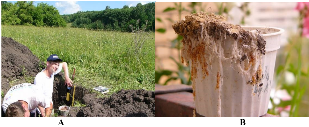
Рис.28. А - Установка сорбционных лизиметров в профиле лугово-черноземной почвы Правобережья Саратовской области аспирантом Кузнецовым П.В. в 2006 году; В – сорбционная колонка, извлеченная из-под лесной подстилки в таежном лесопарке Петрозаводска: на гифах плесневых грибов гирляндами висят белые частицы кварцевого песка и бурые гранулы катионита КУ-2; микроорганизмы – источники микотоксинов, алкалоидов и низкомолекулярных органических кислот (фото Яшина И.М., 2004, 2006).
